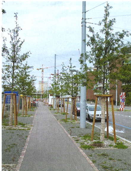
Allee aus Quercus cerris: Pflanzung im Frühjahr 2006 (links), Zustand 2015 (rechts). Das Baums substrat wurde auf der gesamten Breite aufgetragen und der Wegbelag anschliessend eingebaut.
